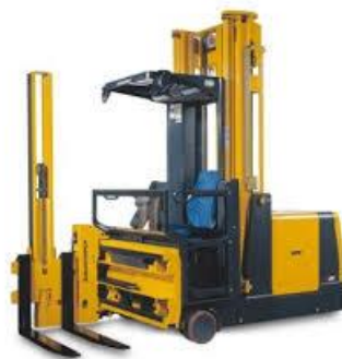
Slika 9 : Viličar sa zakretnim vilicama
