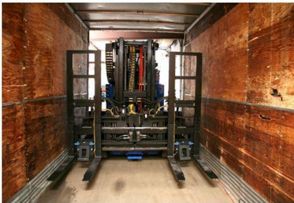
Slika 19. AGV viličar sa dvostrukim parom vilica
