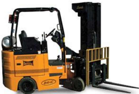
Slika 14. Viličar sa zakretnim jarbolom
